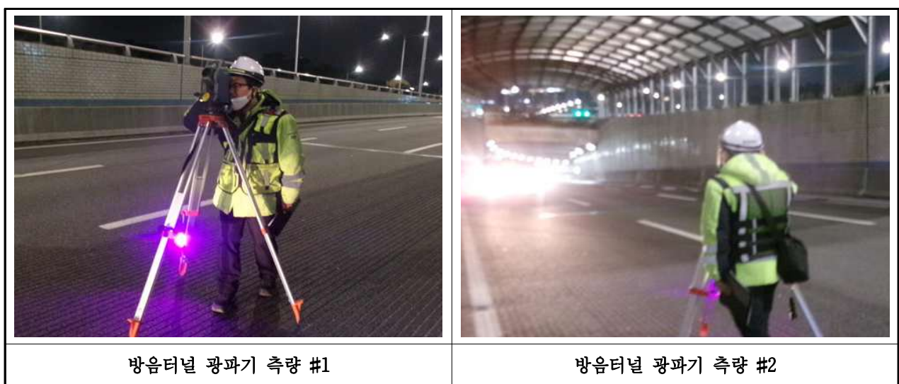
【사진 3.6.2】 광파기를 이용한 변위·변형 측량 현장사진
